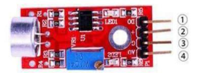
1.DO:digital output 2.VCC: 3.3V-5V DC 3.GND:ground 4.AO:analog output
