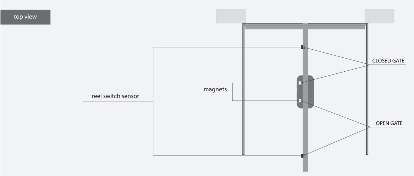
**CONNECTION EXAMPLE OF REEL SWITCH FOR SLIDING GATE**
